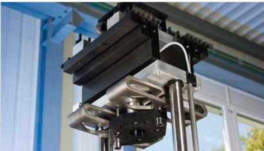
Das RUMUL MAGNODYN-Schwingungserregersystem besteht aus einer in den dynamischen Kraftfluss eingeschalteten, mit einem Elektromagneten kombinierten Elastizität. Der Magnet selbst weist einen relativ kleinen aber konstanten und von der statischen Mittellast vollständig unabhängigen Luftspalt auf. Die daraus resultierende Möglichkeit, die statischen und dynamischen Lastanteile während eines Versuches beliebig zu variieren, erlaubt auch anspruchsvolle Versuchsabläufe.
