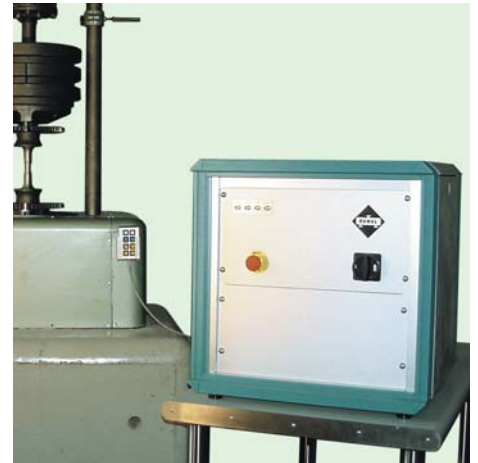
UPGRADE von alten Schwing-Prüfmaschinen
